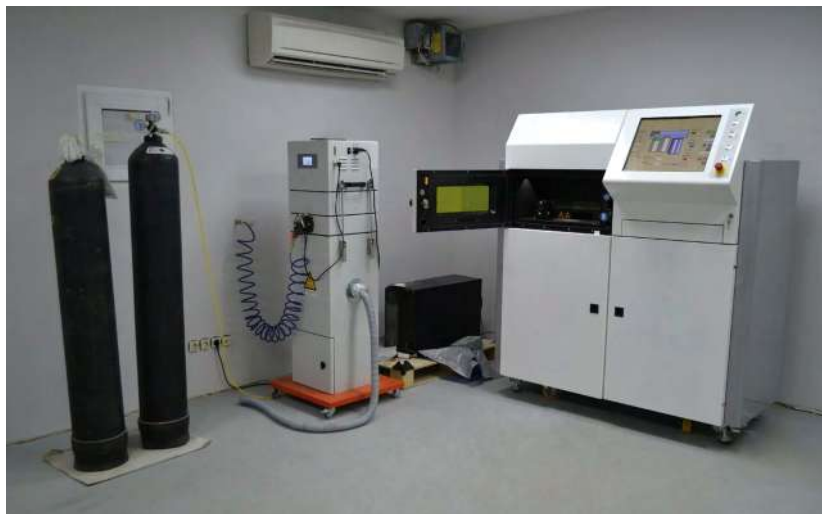
■ Figura 9 ■ Impresora de sinterización láser para metal abierta tras su utilización
