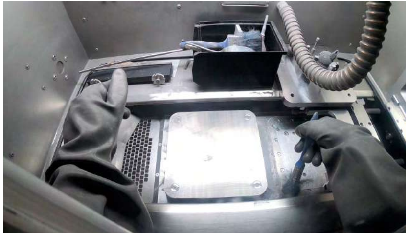
■ Figura 10 ■ Proceso de limpieza tras la impresión de una pieza mediante fabricación aditiva
