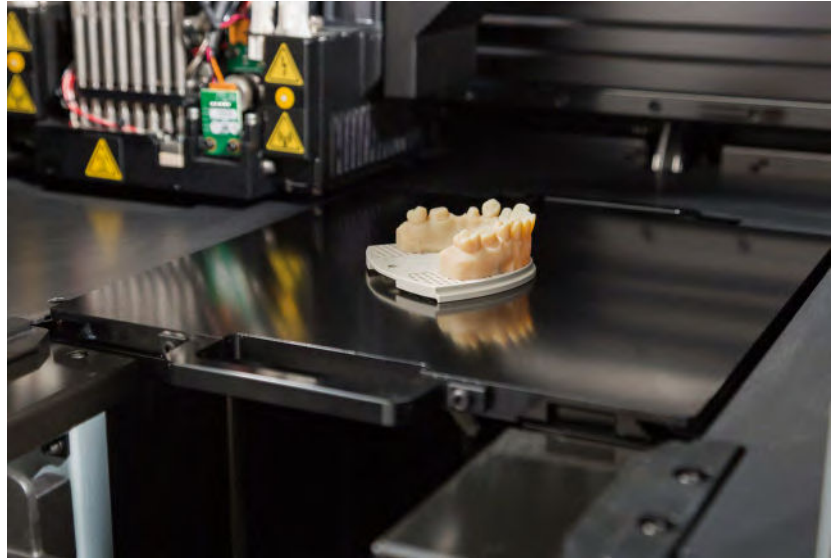
■ Figura 3 ■ Impresora 3D con puente de implante dental impreso
